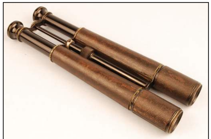
Binocolo kepleriano (detto in inglese twin telescopes) di costruzione francese del 1880 in ottone rivestito in pelle.
