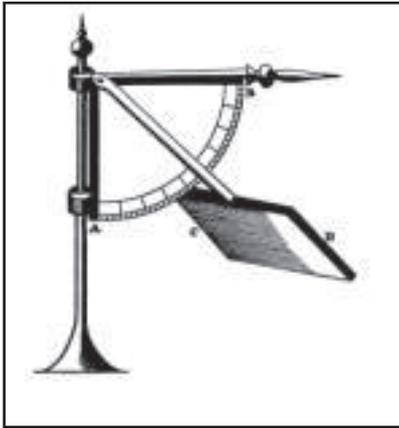
**L'anemometro a "pendolo" di R. Hooke.**
