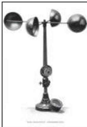
di conoscere il numero dei giri in un periodo di tempo da cui poter ricavare la velocità del vento secondo il principio, sperimentato da Robinson, che le tazze si muovono ad un terzo della velocità del vento.
